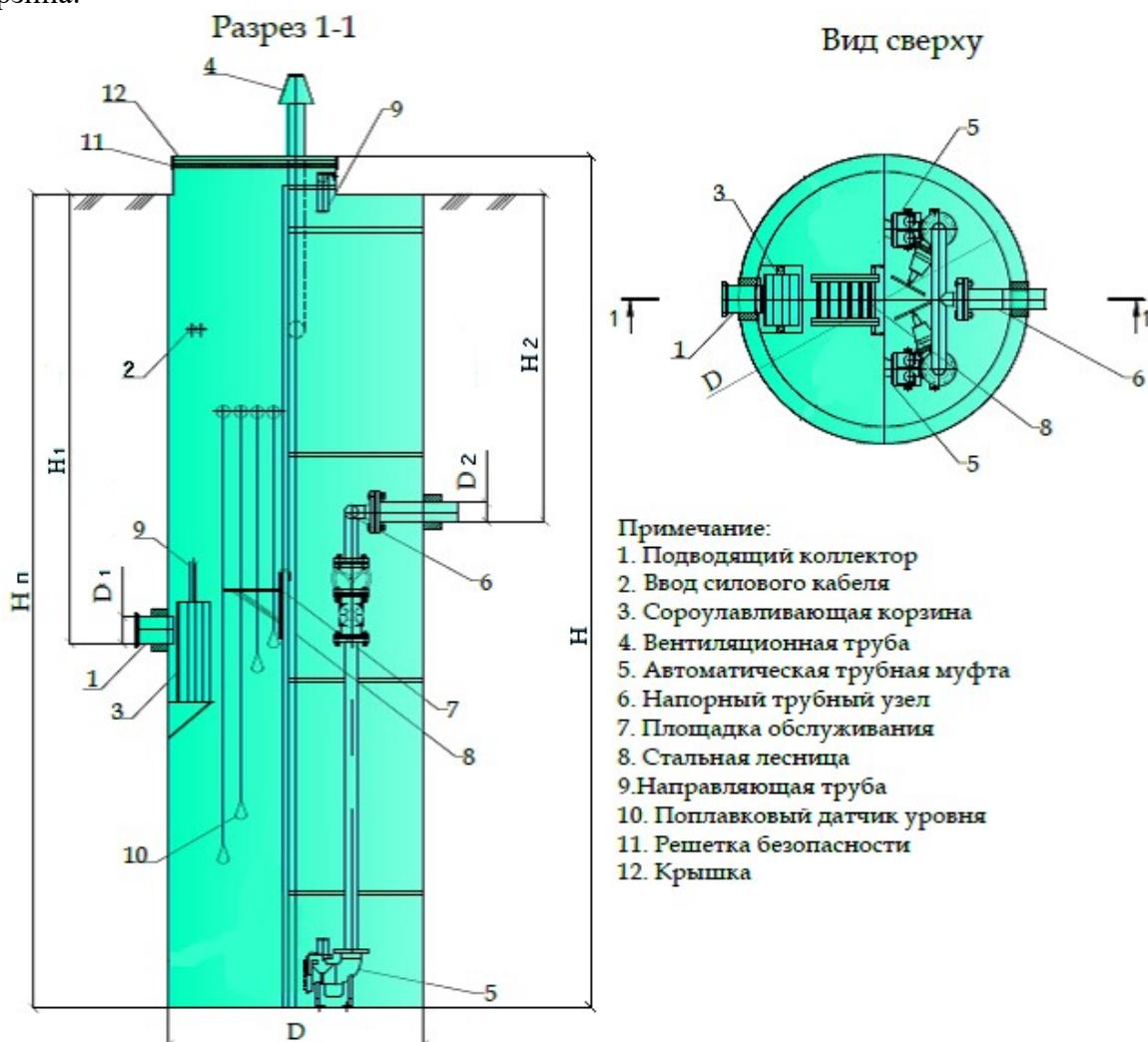
В нижней части резервуара, установлены насосы погружного типа с всасывающими патрубками. Насосы установлены с возможностью вертикального перемещения по направляющим, и крепятся к трубному узлу без болтовых соединений по средствам
